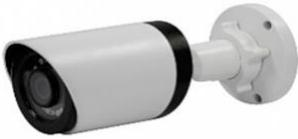
IP видеокамера уличная цилиндрическая с ИК подсветкой,  $f=2,8$  мм, угол обзора по горизонтали  $101^\circ$ , двухмегапиксельная, 1920x1080, 30к/с, 1/2.8" SONY STARVIS сенсор 0.01 Люкс (день) / 0.001 Люкс (ночь) / 0 Люкс (с ИК подсветкой), встроенная видеоаналитика, BLC, WDR, DWDR, DNR, ROI, антитуман, H.264/H.265, e-mail, механический ИК фильтр, DC 12V, PoE, герметичный разъем Ethernet, адаптивная ИК подсветка 30м,  $-40+50^\circ\text{C}$ .
